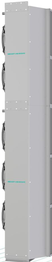
**安装位置:** 立式侧吹风幕机一般安装在门的一侧，常见于商场、酒店、餐厅、工厂等建筑物的出入口。对于双向通行的大门，可在门的两侧都安装，以确保更好的风幕效果。安装高度通常以风幕机底部距离地面 2.2 米至 2.5 米为宜，这样能使风幕均匀地覆盖门口区域，有效阻挡外界空气、灰尘、蚊虫等进入室内。
